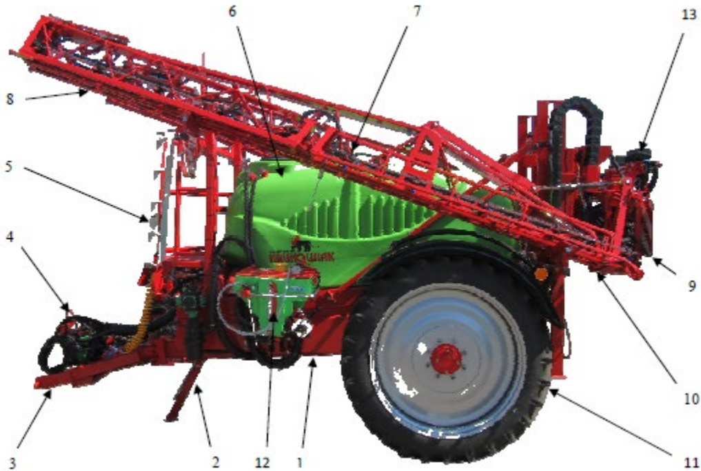
Rysunek 5. Budowa opryskiwaczy ORION 2500/3000 PHB.
